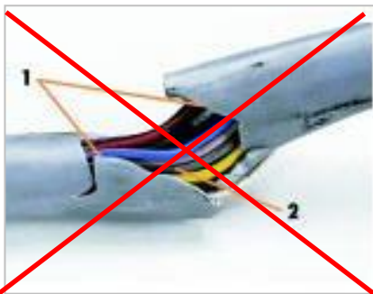
Sliki: Nedovoljena uporaba električne opreme in inštalacije
