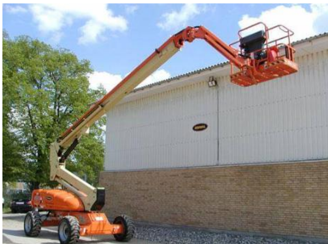
Primeri ustreznega dostopa na streho posameznega objekta
